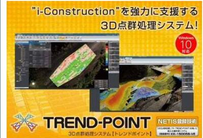
各種スキャナーやドローン等で計測した膨大な点群データを高速処理。断面作成、メッシュ土量計算が可能。"i-Construction"の出来形管理要領にも対応。
